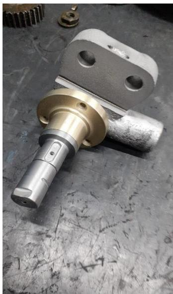
Figura 25: Fabricação do eixo e engrenagem faltante. Fonte própria
