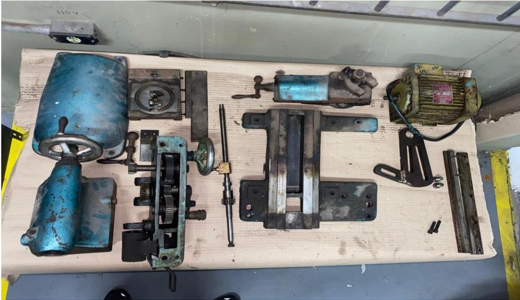
Figura 15: peças desmontadas retiradas do torno. Fonte; própria.
