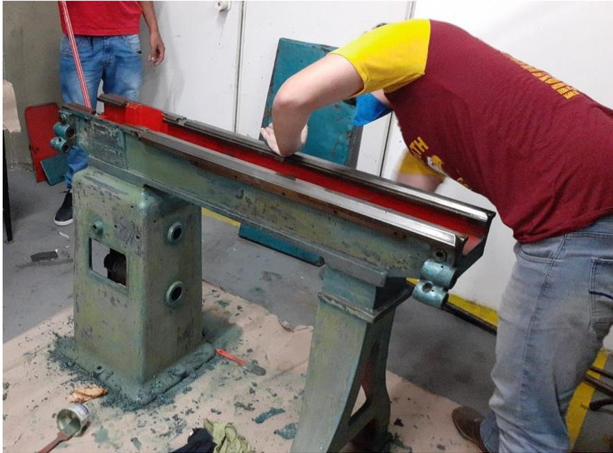
Figura 20:Retirando a tinta antiga . Fonte própria
