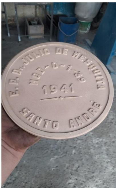
Figura 29: Jateamento na placa de bronze do torno mecânico . Fonte própria
