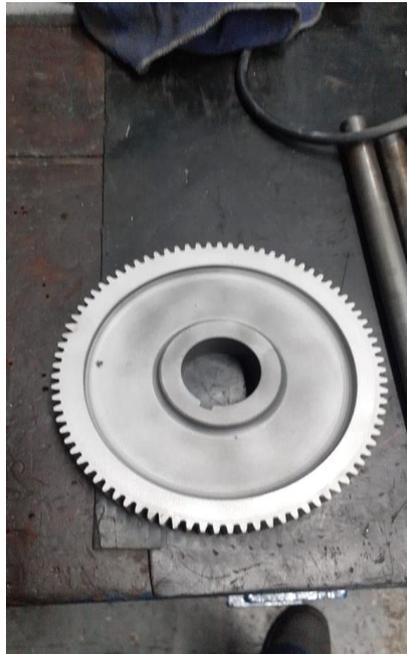
Figura 27: Recuperação dos dentes da engrenagem por meio da eletroerosão a fio . Fonte própria
