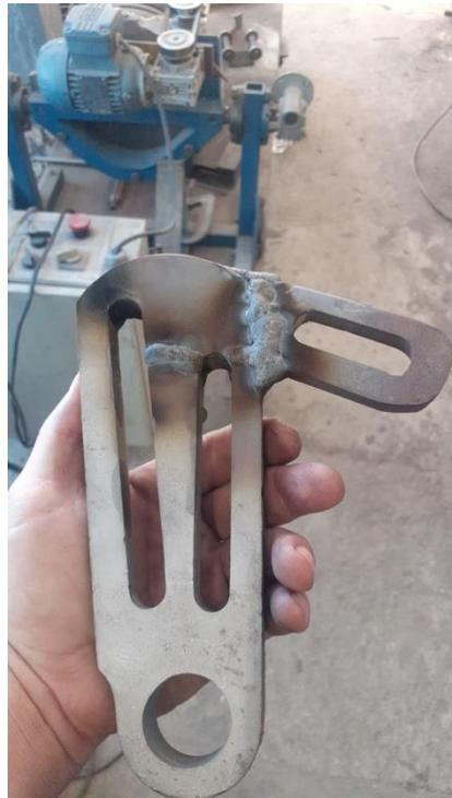
Figura 26: Recuperação com solda do suporte do recambio. Fonte própria
