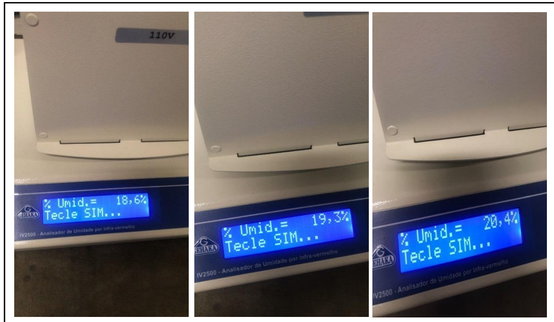
Figura 8 - Resultado do teste de umidade por infra vermelho.
