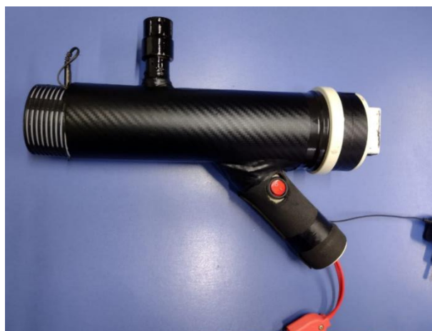
Figura 9 - Protótipo finalizado do nebulizador com aquecimento
