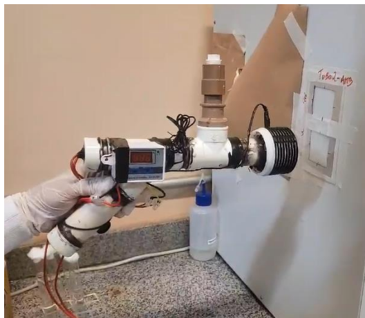
Figura 2 - Protótipo em funcionamento nos testes microbiológicos
