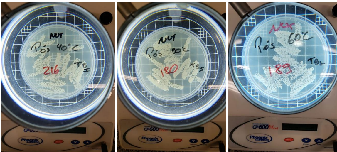
Figura 5 - Resultados do crescimento de S.aureus em ágar nutriente no processo de pós-desinfecção com água nebulizado e aquecido, após 5 minutos de ação
