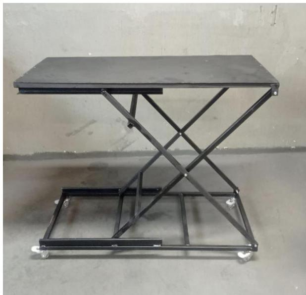
FIGURA 26 - Mesa Após a Instalação dos Rodízios.
