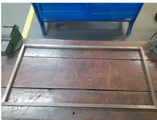
FIGURA 11 - Soldagem das Extremidades das Barras
