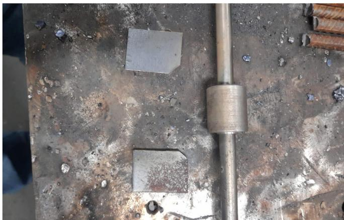
FIGURA 28 - Roldana Para a Barra do Macaco Hidráulico.
