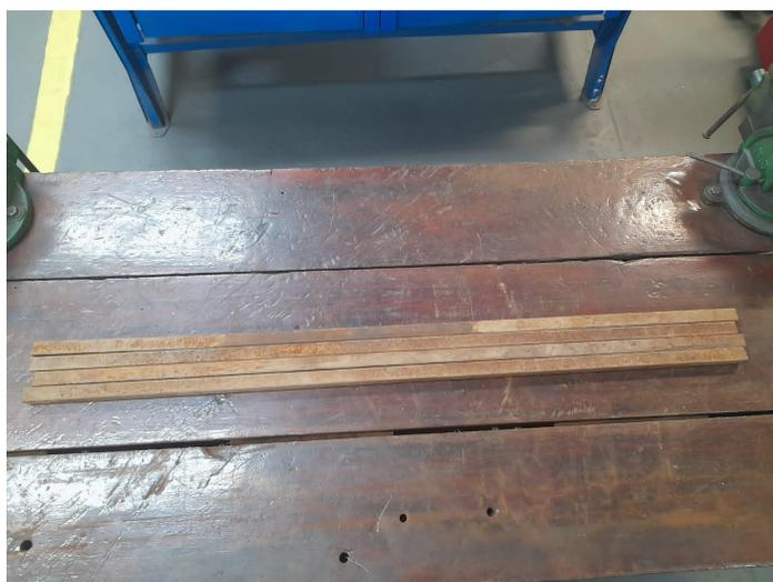
FIGURA 9 - Limpeza de Ferrugem nas Barras
