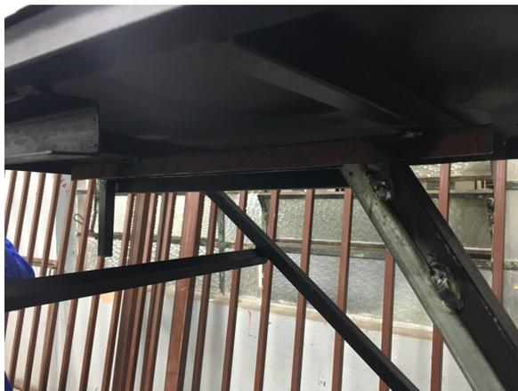
FIGURA 30 - Roldana Fixada no Trilho Inferior da Mesa.
