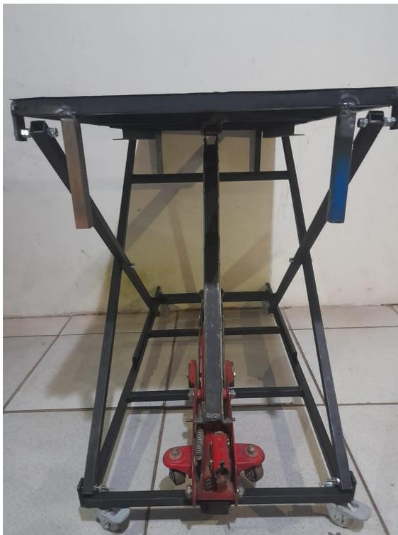
FIGURA 32 - Estrutura de Suporte ao Macaco Hidráulico
