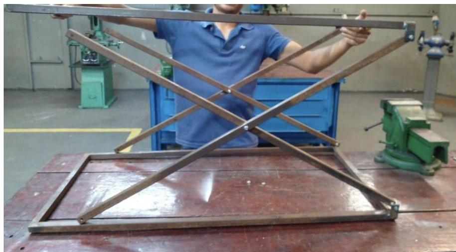
FIGURA 15 - Corte e fixação das barras nas dobradiças.
