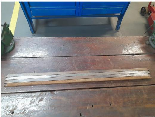
FIGURA 10 - Corte das Extremidades das Barras em 45 Graus
