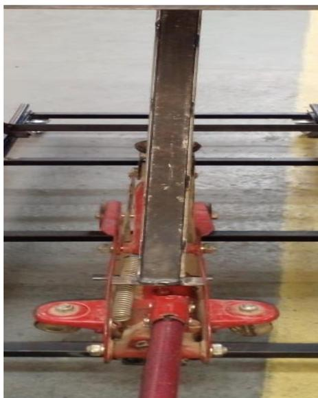
FIGURA 27 - Soldagem de Uma Barra no Macaco Hidráulico.
