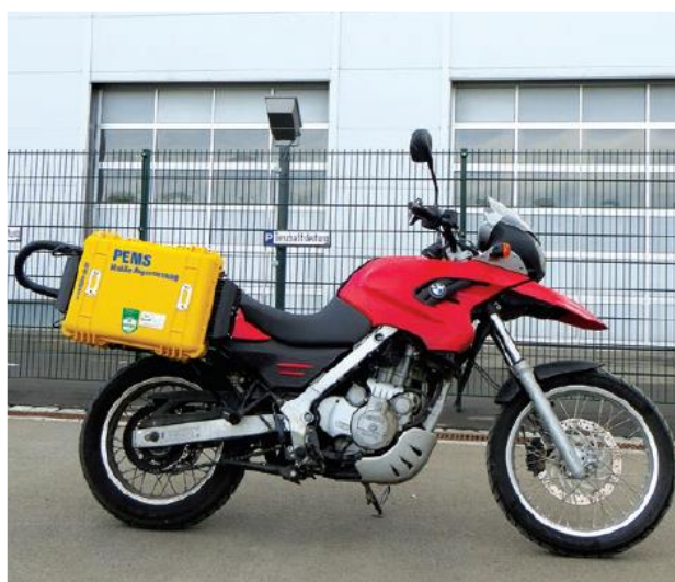
Figura 19 – Sistema de medição mini-PEMS desenvolvido pela MAHA-AIP
