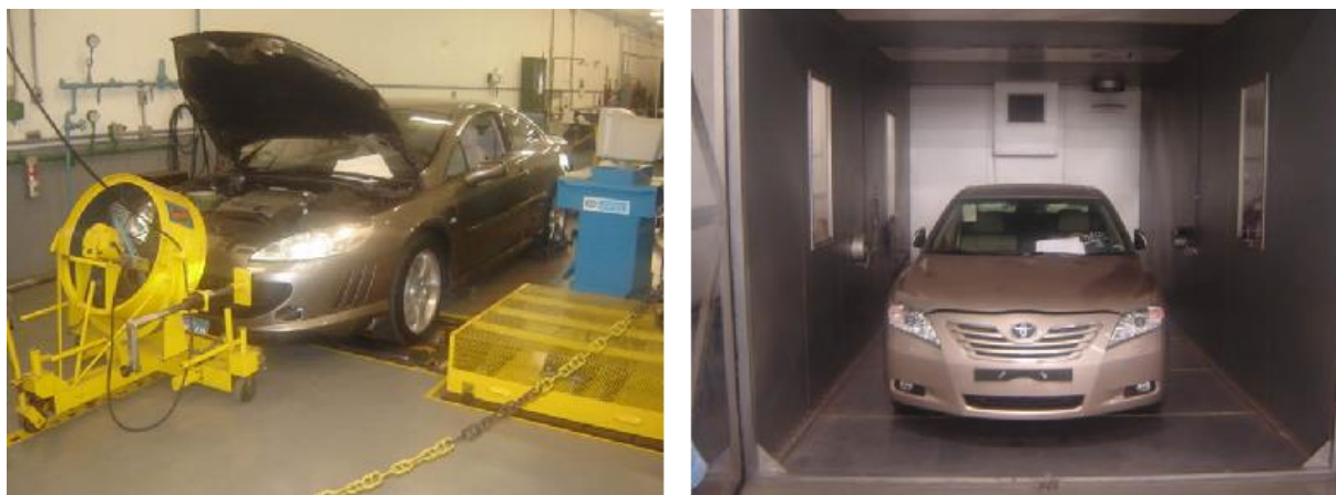
Figura 11 – Ensaio de emissões de poluentes em laboratório
