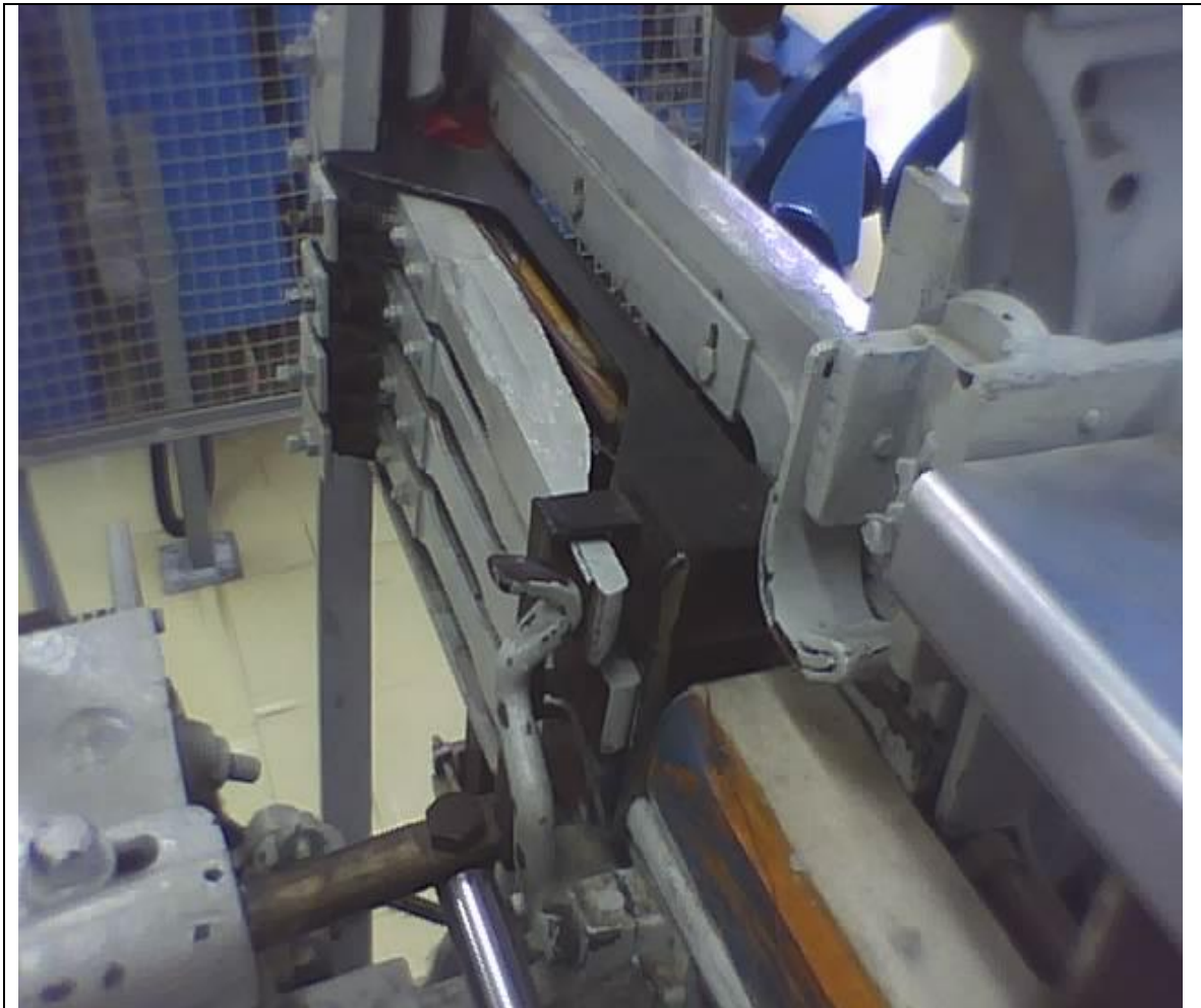
Inserção por lançadeira (Foto tirada no SENAI –SP)
