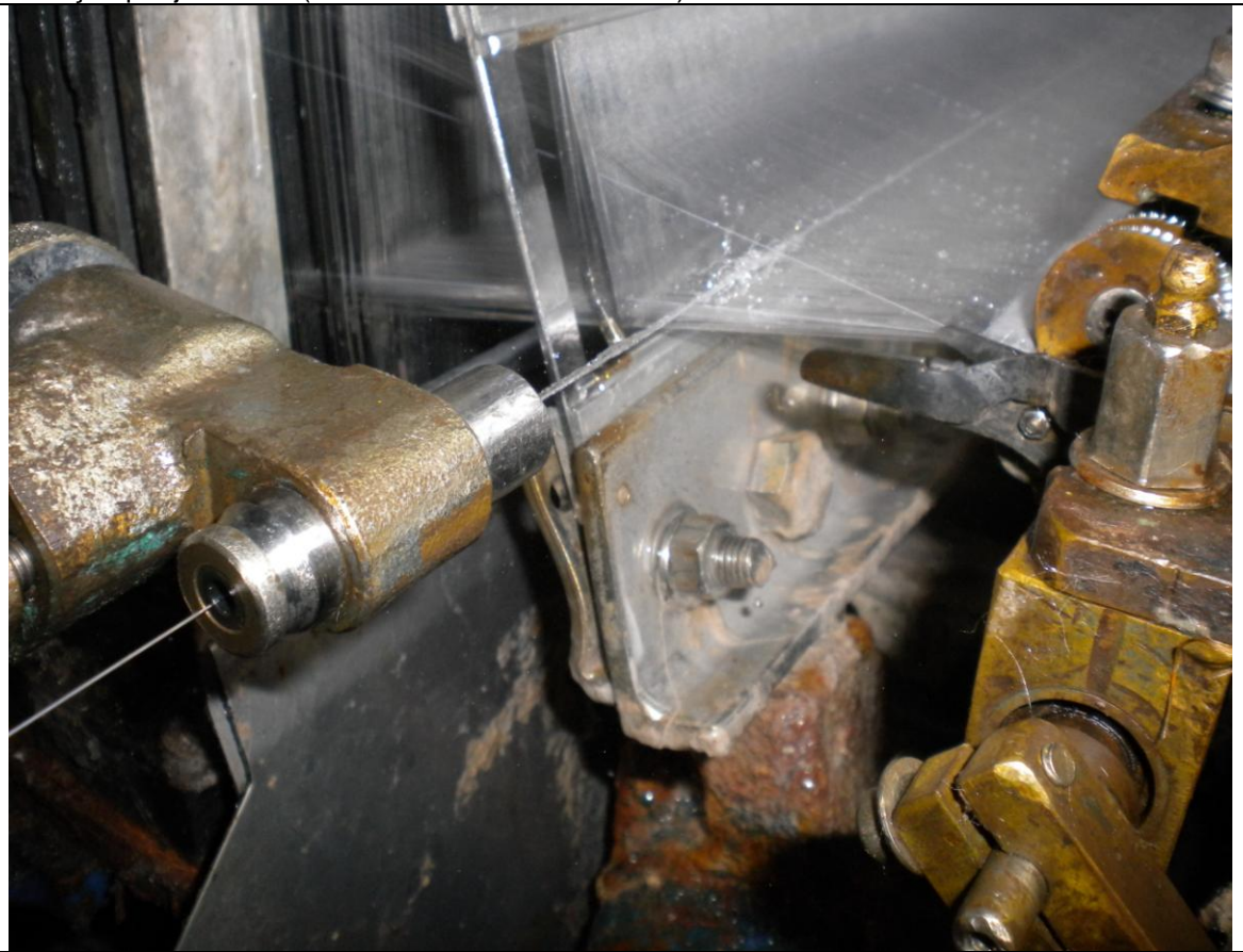
Inserção por jato d'agua (Foto tirada na Têxtil Leonilda)
