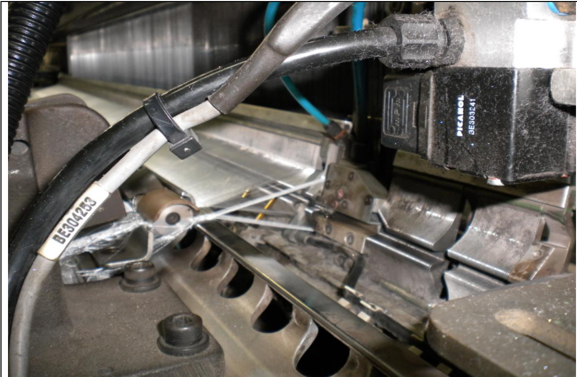
Inserção por jato de ar (Foto tirada na Têxtil Leonilda)
