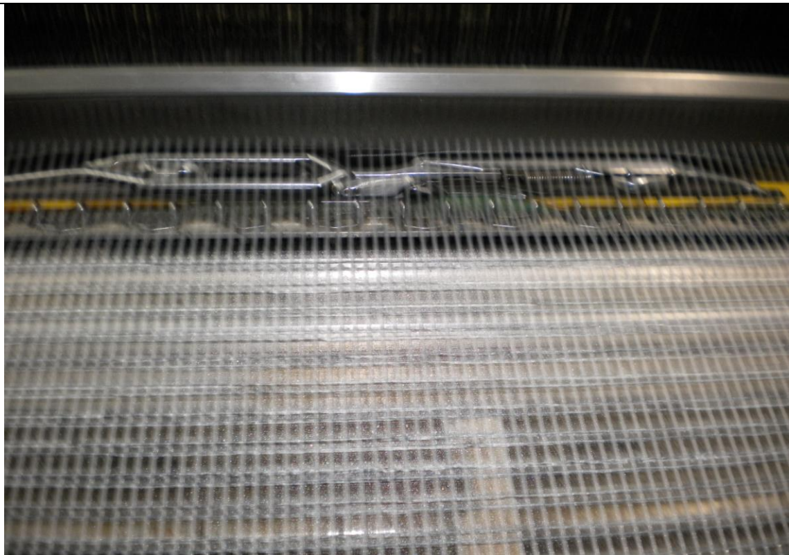
Inserção por pinça rápida (Foto tirada na Têxtil Leonilda)
