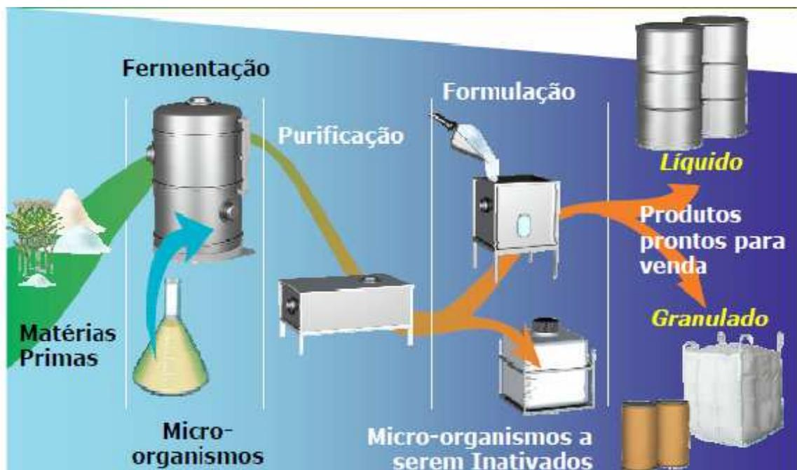
Figura 6 Processo de fabricação das enzimas. (GOMES, 2010)
