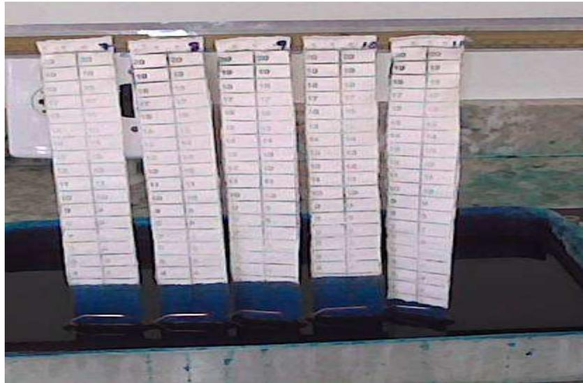
**Figura 9 - Amostras mergulhadas em corante, teste de capilaridade.**
