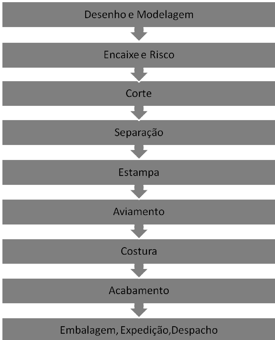
Figura 13 – Processo de Confeção da camiseta
