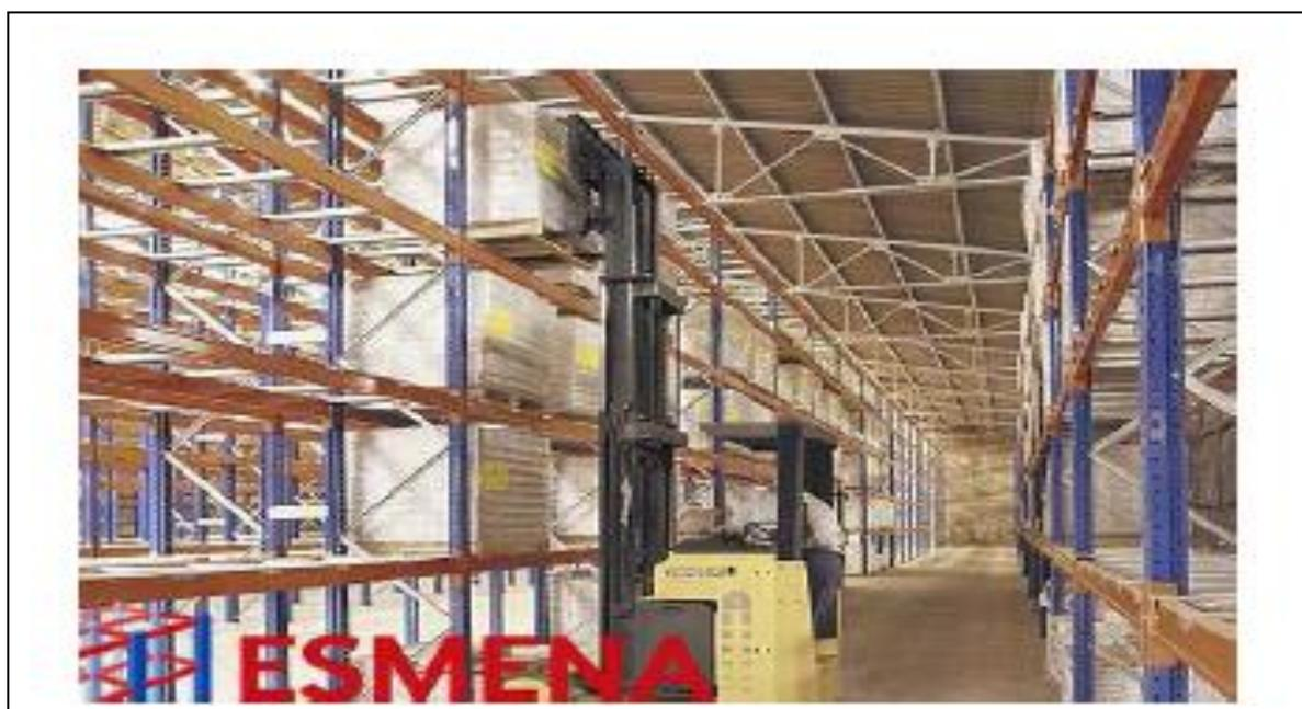
Figura 13 - Operação de empilhadeira em Estrutura de armazenagem Porta-Paleta
