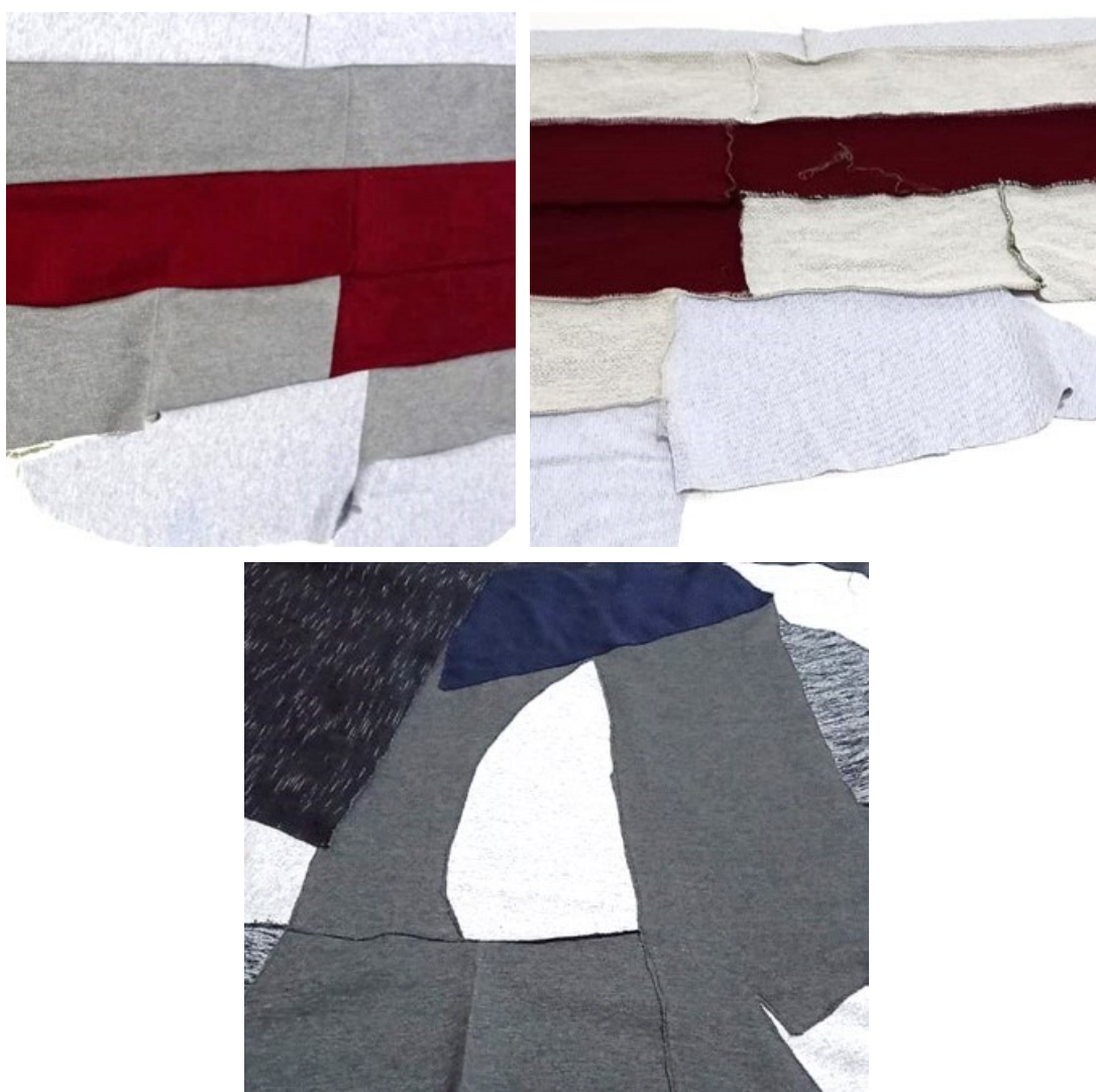
Figura 63 – Diferença da costura em overloque (acima) e reta (abaixo)
