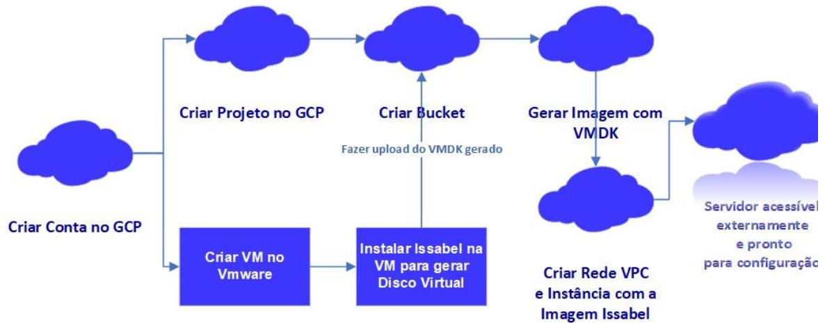
Figura 1 – Fluxo de criação do servidor no GCP
