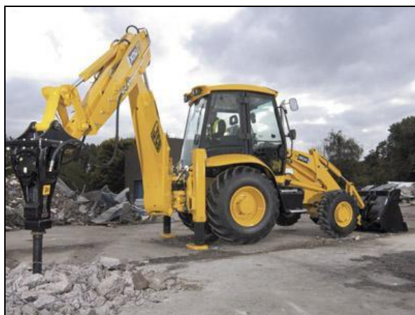
Figura 18: Trator pá- carregadeira com rompedor hidráulico acoplado.
