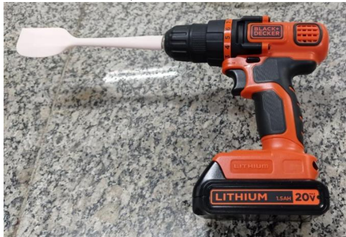
Figura 3: Parafusadeira, à bateria, com uma espátula de silicone adaptada.
