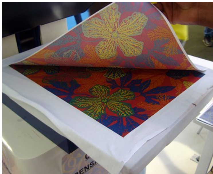
Figura 53: Revelação da estampa por meio de sublimação
