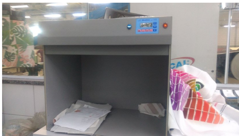
Figura 61: Equipamento para controle de qualidade da estampa: Cabine de luz
