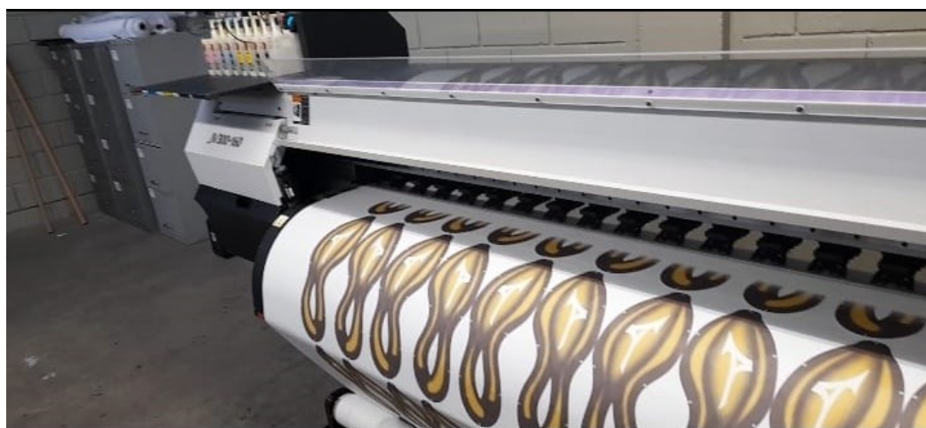
Figura 57: Máquina de estamparia pelo processo de impressão digital modelo JV300-160
