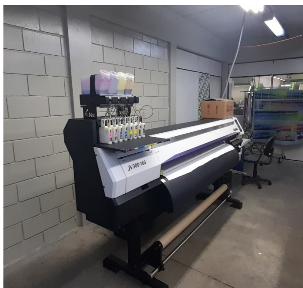
Figura 63: Máquina de estamperia digital modelo Mimaki JV300-160
