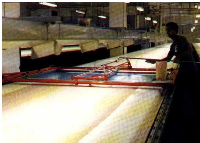
Figura 51: Processo de estampagem a quadros
