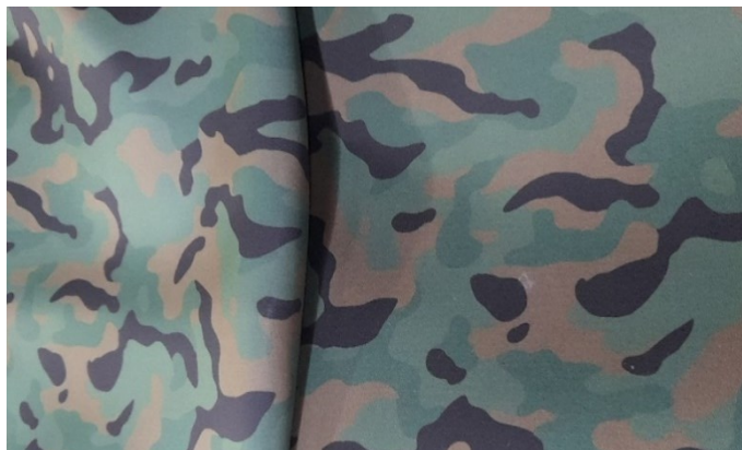
Figura 65: Tecidos estampados no sistema digital pelo processo de sublimação: Diferença de coloração
