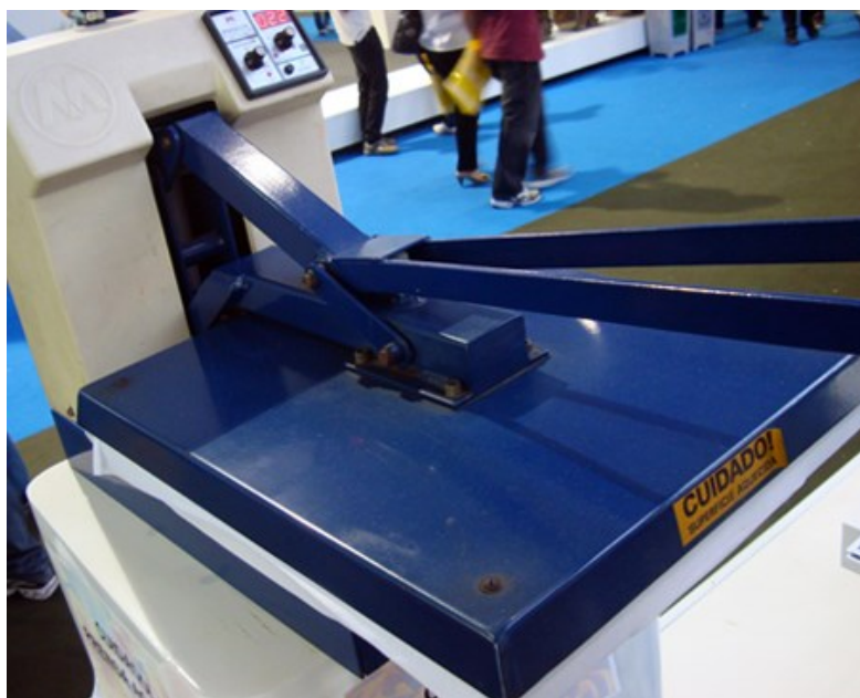
Figura 52: Prensa térmica aquecida em processo de sublimação
