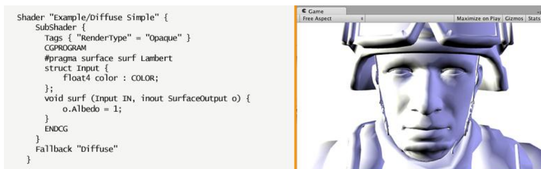
Figura 16 - Exemplo do código de um “Shader de Superfície” e o resultado de sua aplicação.
