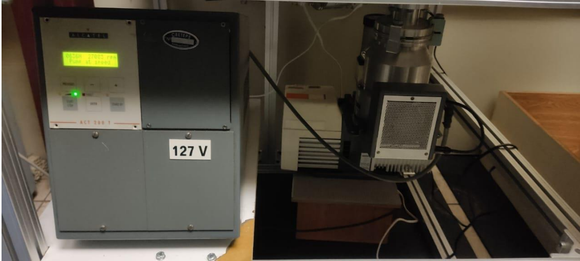
Figura 24: bombas de vácuo ligadas na câmara de expansão.
