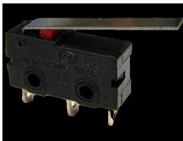
Figura 3 - Chave Micro switch
