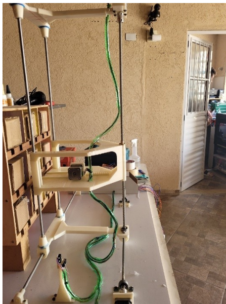
Figura 89- Organização dos cabos elétricos
