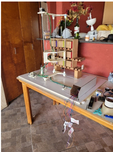
Figura 87- Confeção das caixas e posição do sensor de cor
