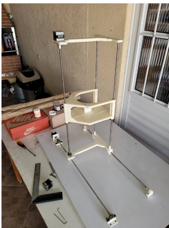
Figura 78- Fixação do mecanismo a base
