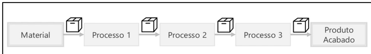
Figura 1 - Sistema de produção empurrado
