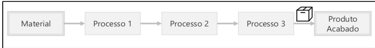
Figura 2 - Sistema de produção puxado
