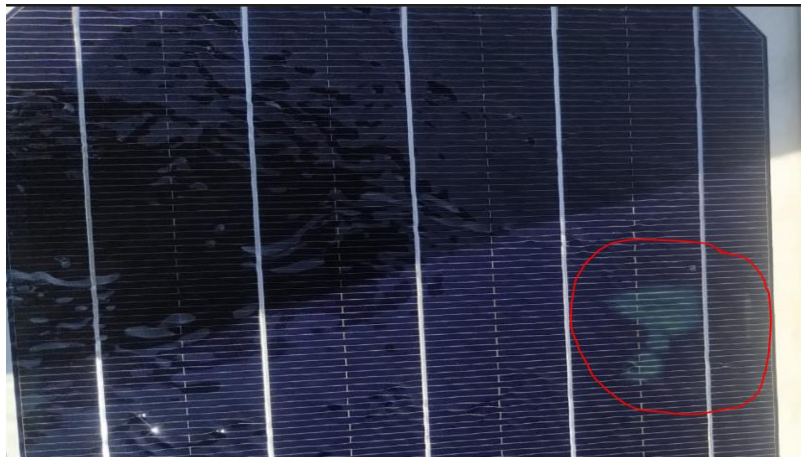
Figura 13 - Ponto quente encontrado na célula fotovoltaica monocristalina.
