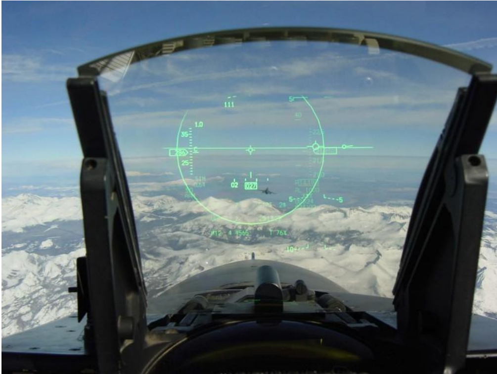
Figura 12 Exemplo de display óptico sem obstrução da visão
