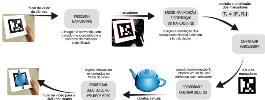
Figura 14 Fluxo de funcionamento de uma aplicação em RA Utilizando ARToolkit
