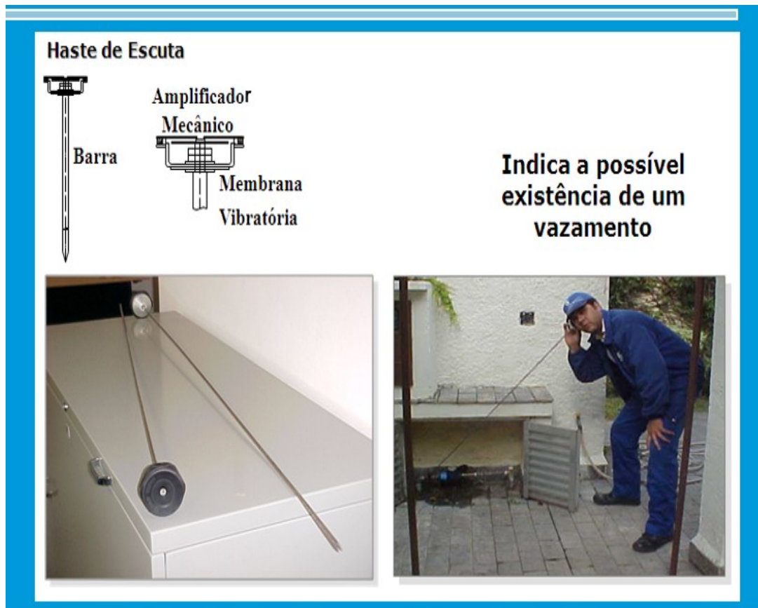
Figura 15: Funcionamento da Haste de Escuta
