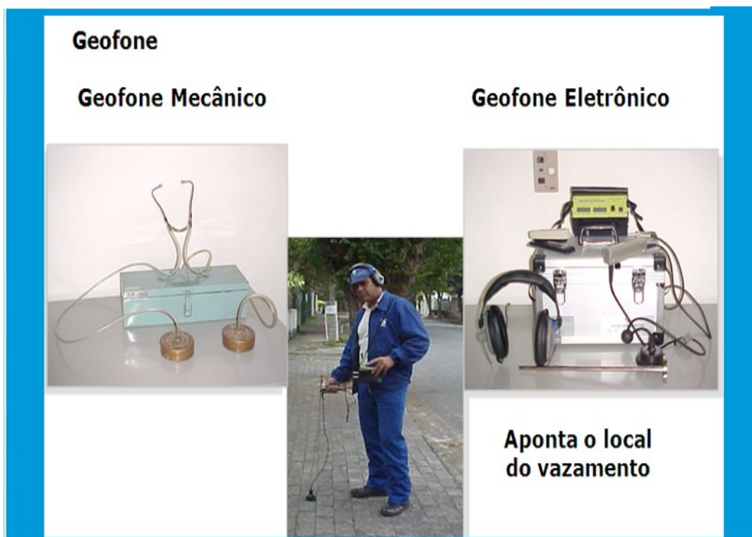
Figura 16: Funcionamento dos Geofones Mecânico e Eletrônico
