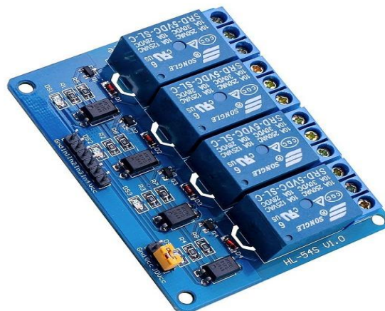
Figura 10 - Módulo Relé 5V de 4 Canais com Optoacoplador
