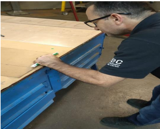
Figura 19 - Fixação da Cantoneira na Estrutura
