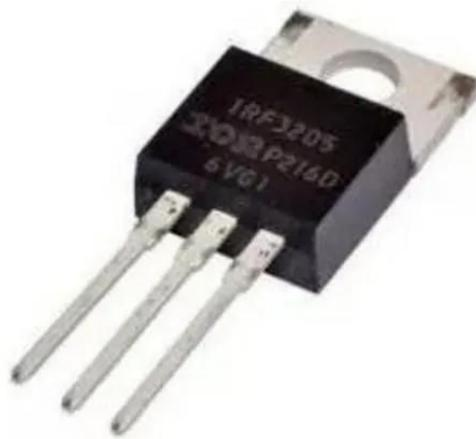
Figura 3.2: mosfet de potencia irf3205. Fonte:
