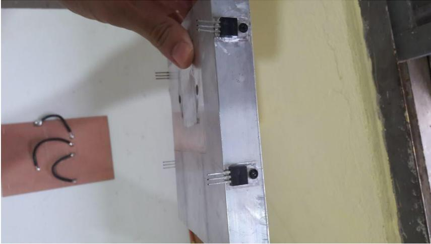
Figura 4.2: mostra como os mosfets estão sendo fixados no dissipador, no primeiro protótipo. Fonte: Própria autoria
