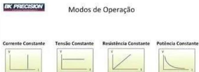
Figura 3.1: Modos de operação da carga eletrônica. Fonte: <https://www.raisa.com.br/o-que-e-cargaeletronica>
