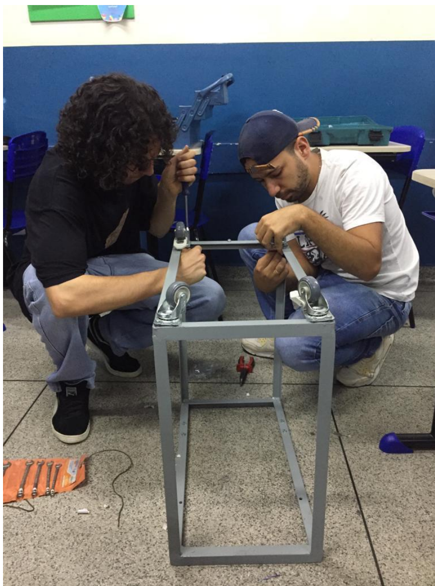
Figura 28 – Rodízios inseridos na base inferior do kit elevador didático.
