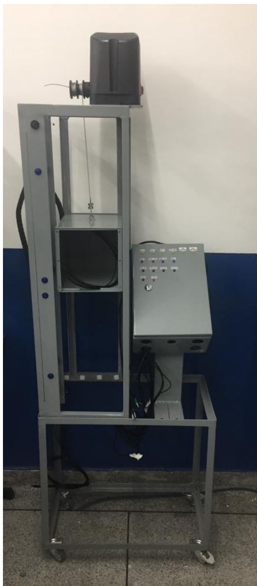
Figura 38 – Kit Elevador Didático para Programação em CLP.
