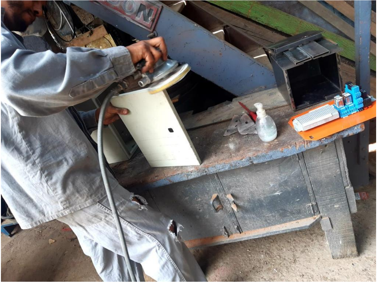
Figura 22 – Lixamento da porta da cabine.
