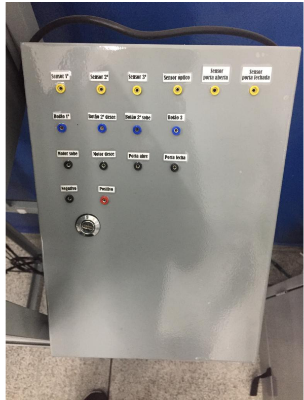
Figura 36 e 37 – Conexão elétrica dos bornes na cabine do painel.
