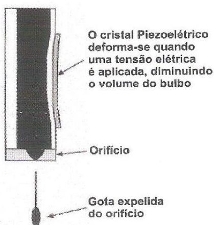
Figura 21: Esquema de cabeça com transdutor piezoelétrico na parede
