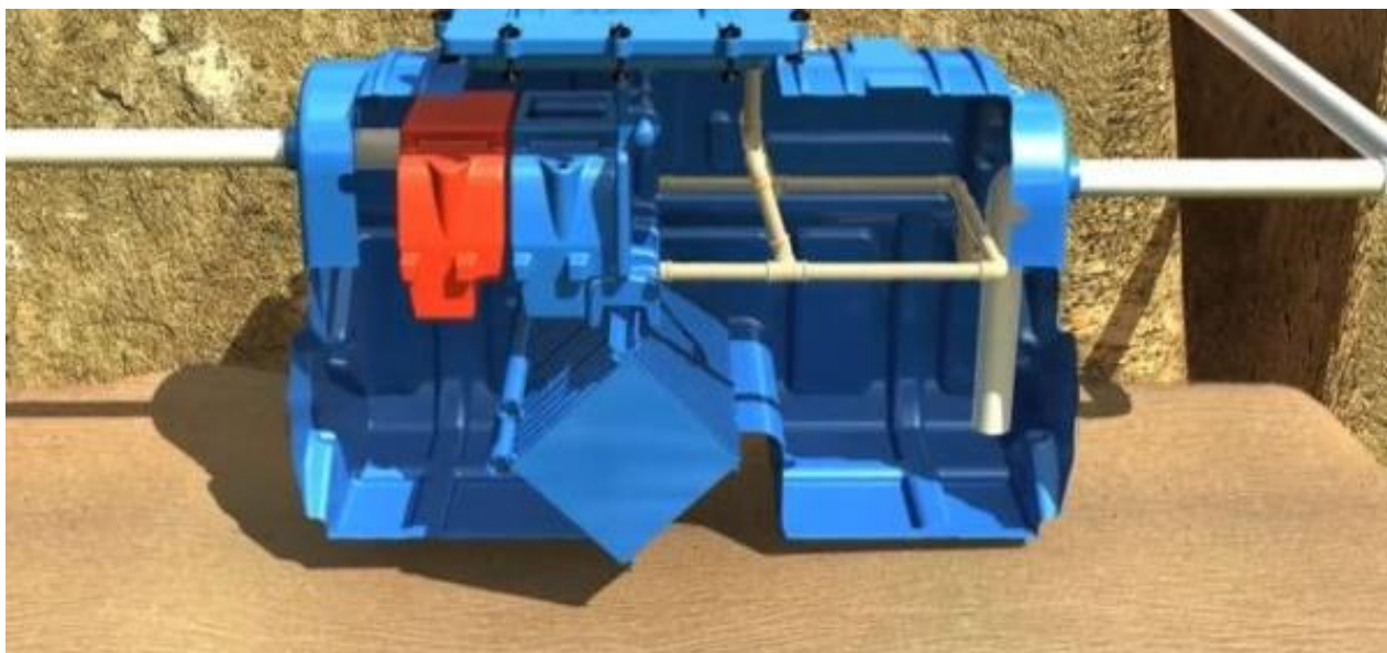
Figura 23 – Módulo separador de sólidos do modelo da caixa SUPERFLOW
