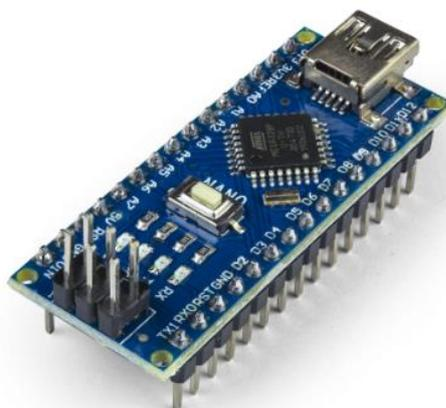
Figura 4. Arduino Nano. Imagem da Internet. Out/2022
