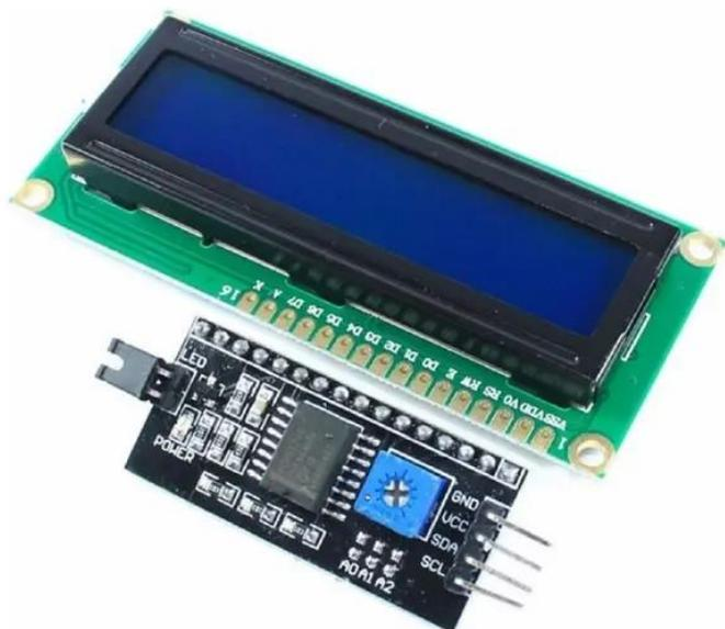
Figura 10. Display LCD I2C 16X2. Imagem da Internet. Out/2022
