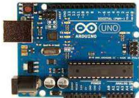
Figure 1 - Imagem do Arduino Uno utilizado no protótipo.
