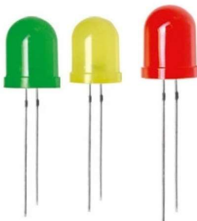
Figure 4 - LED's que foram empregados no circuito
