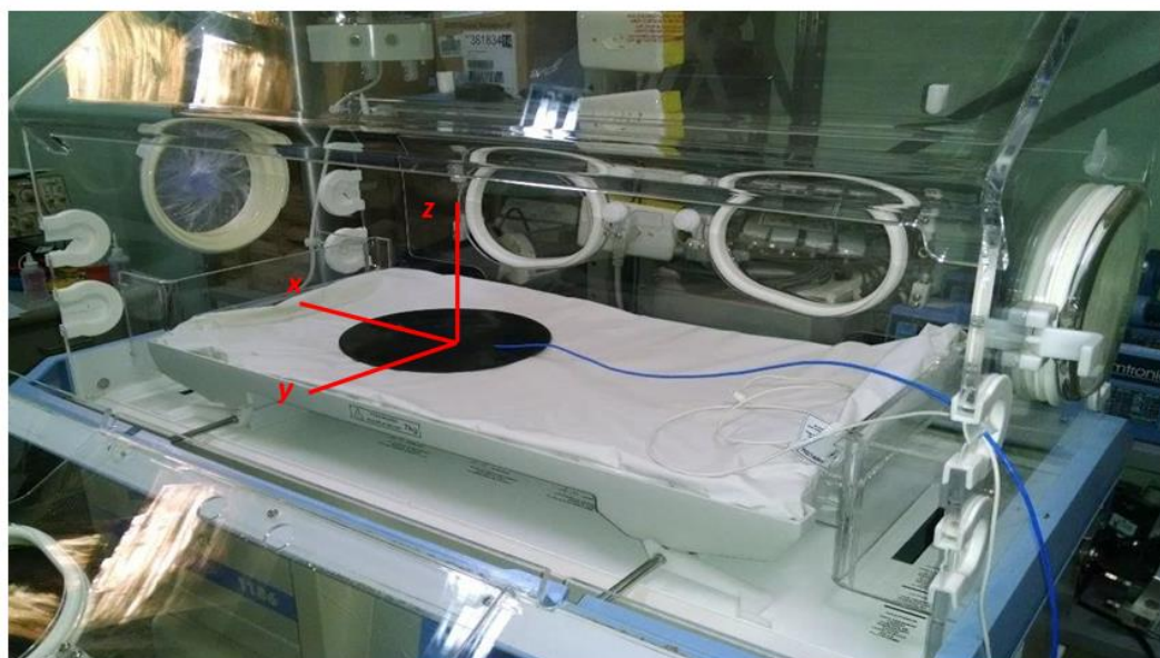
Figura 4 – Posicionamento dos eixos na incubadora
