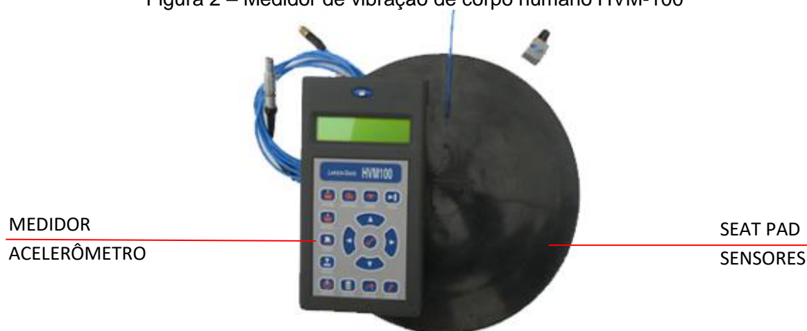
Figura 2 – Medidor de vibração de corpo humano HVM-100
