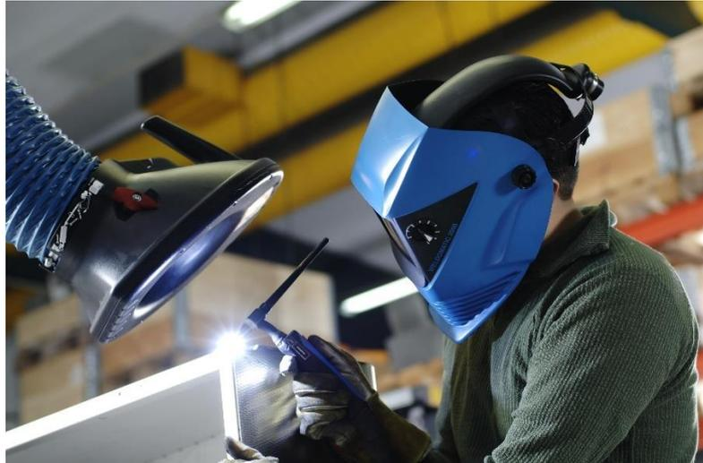
Figura [02]: Captação de fumos de solda. [5]
