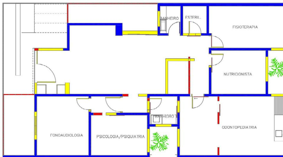
Figura 13: Planta de demolição e construção (Azul: manter; Vermelho: Construir / alterar; Amarelo: demolir)
