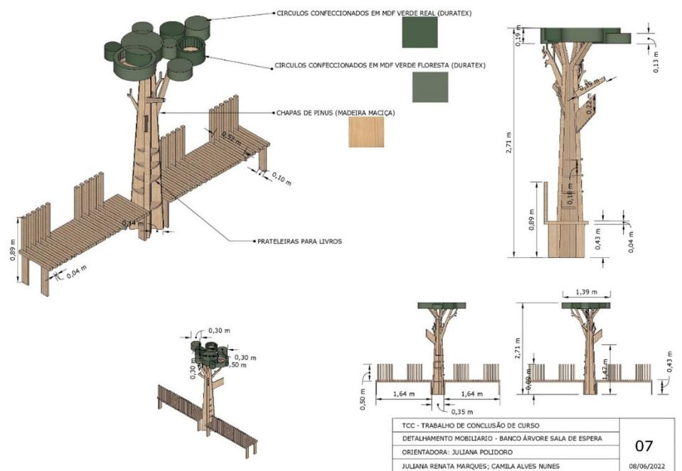
Figura 88: Detalhamento de mobiliário – banco árvore (sala de espera). Imagem confeccionada pelo autor nos programas Sketchup + layout.
