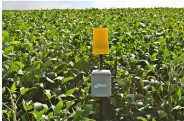
Figura 7: sistema Iot de detecção de pragas.
