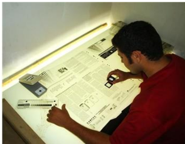
Figura 7: Gravação de chapa por fotolito (FTP) Fonte: ARTEFILM, 2012
