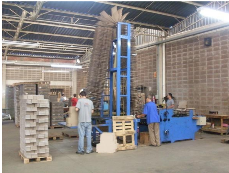
Figura 24: Aplicação de cola para montagem Fonte: O autor, 2011
