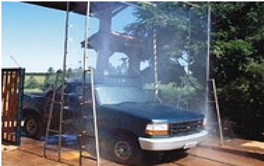
Figura 10: Desinfecção de veículos através do rodolúvio.
