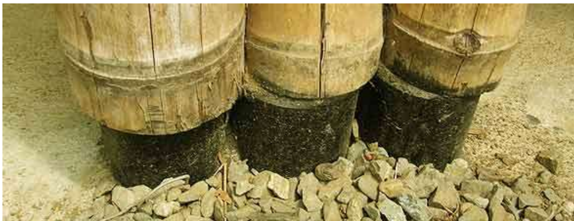
Figura 02 – Colmos de bambu infestados de caruncho
