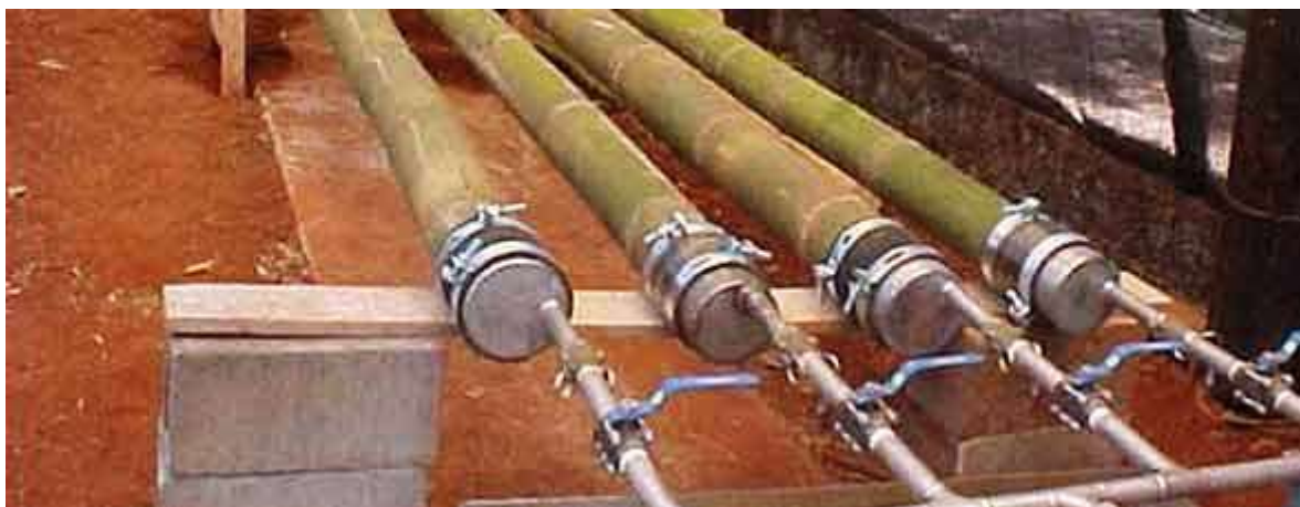
Figura 10 – Bambu recebendo o tratamento boucherie
