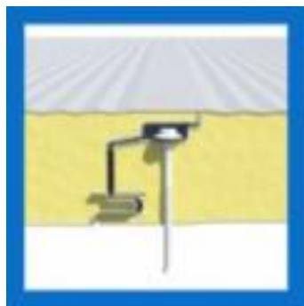
Figura 11 - Sistema de Fixação das Placas (Fonte: http://www.isoeste.com.br/ )
