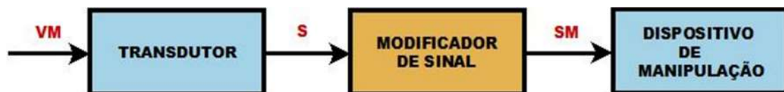
Figura 7 – Elementos de um instrumento inteligente.
