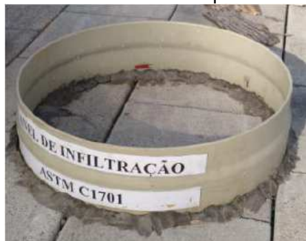
Figura 6: Anel de PVC calafetado sobre superfície de concreto permeável
