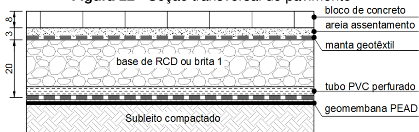
Figura 22 - Seção transversal do pavimento
