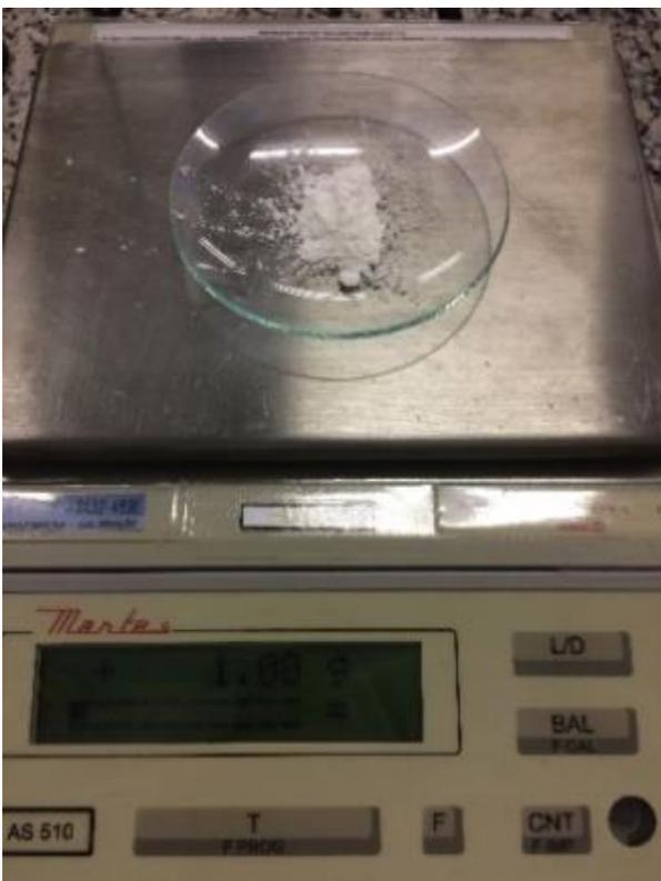
**Figura 4: Pesagem do Pantotenato de Cálcio em um vidro de relógio.**
