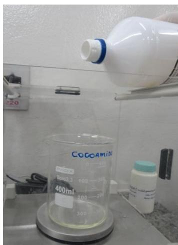
Figura 3: Pesagem do Cocoamidopropil Betaína.
