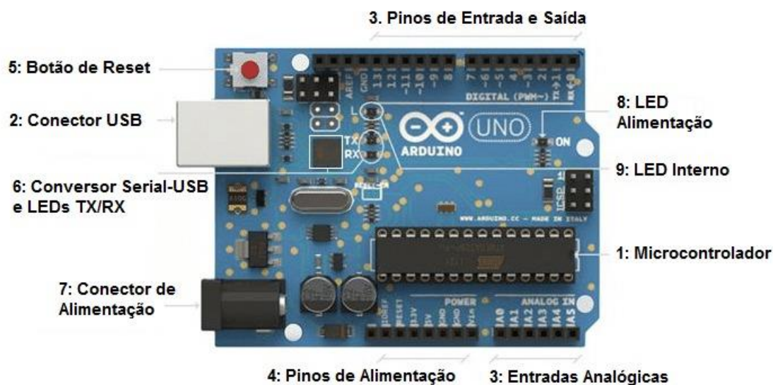
Figura 10 – Placa Arduino
