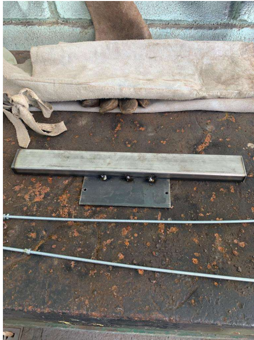
Figura 4- Travamento das colunas, guia dos varões.
