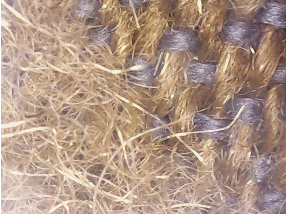
Figura 38: Detalhe da perda de dublagem do macacão de 1964 Fonte: Elaborada pela autora
