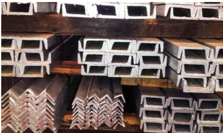
*Figura 23 - Perfis de aço galvanizado*
