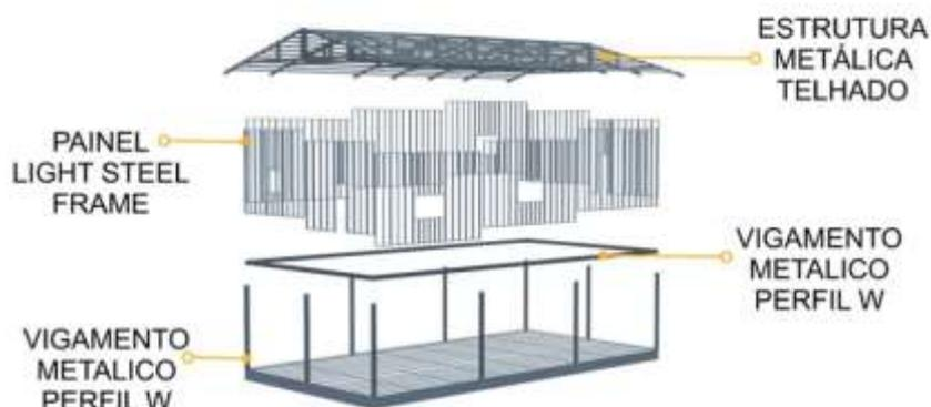
*Figura 18: fundação para Light Steel Frame*
