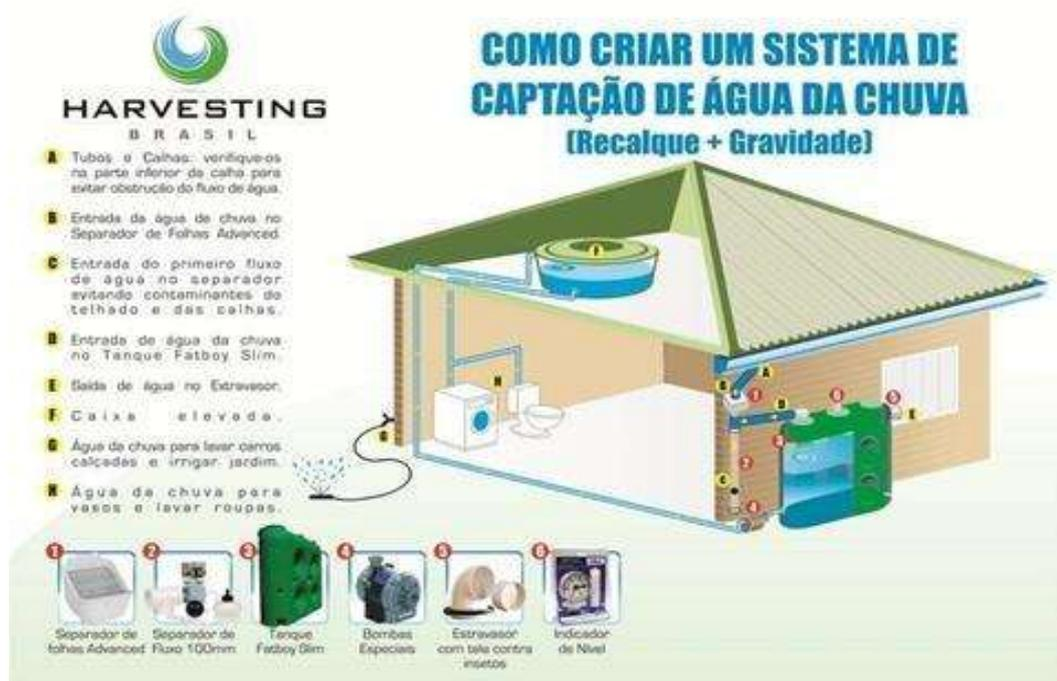
*Figura 31 - Modernização na captação de água*
