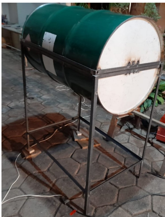
Figura 8 – Soldagem da estrutura geral.
