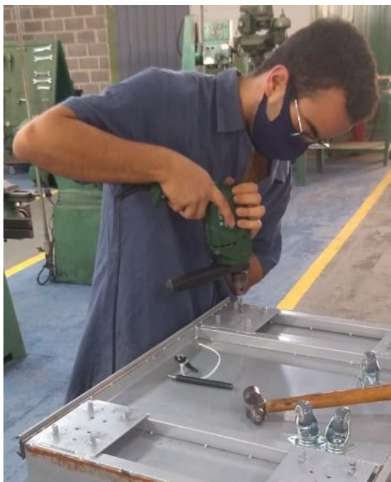
Figura 3 – Trabalhando com instalação de rodízios.
