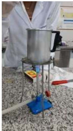
Figura 2: Solução sendo aquecida no Bico de Bunsen a 150°C (fervura)
