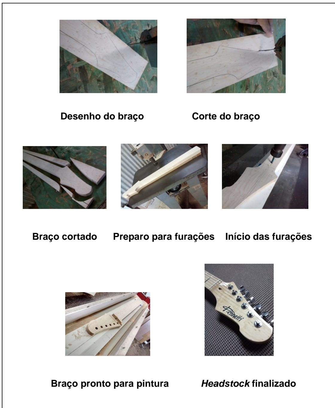
Figura 8- Etapas do processo de construção do braço de uma guitarra
