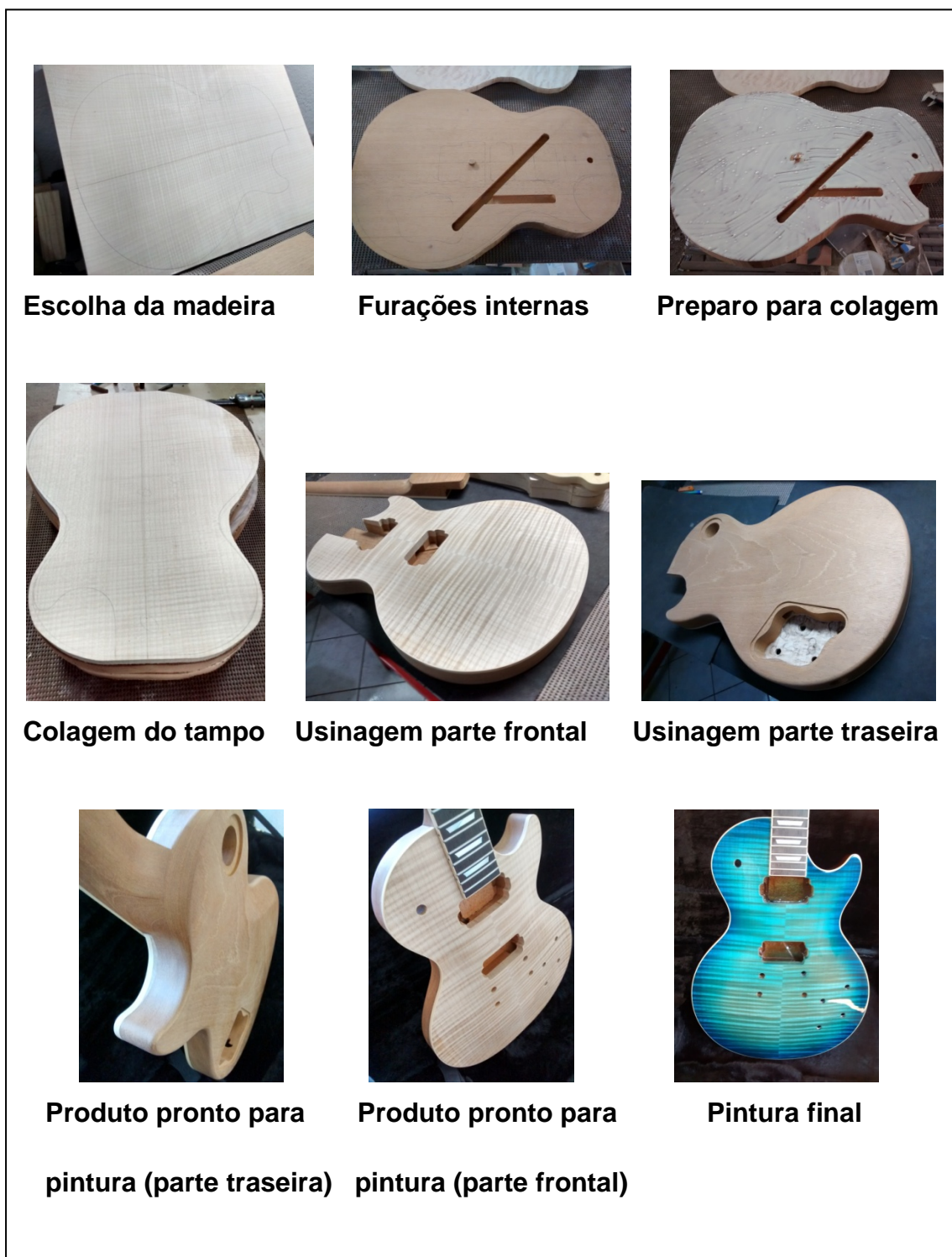
Figura 7 - Etapas do processo de construção do corpo de uma guitarra
