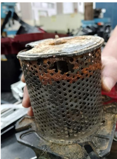
Figura 4 – Vista lateral do filtro degradado
