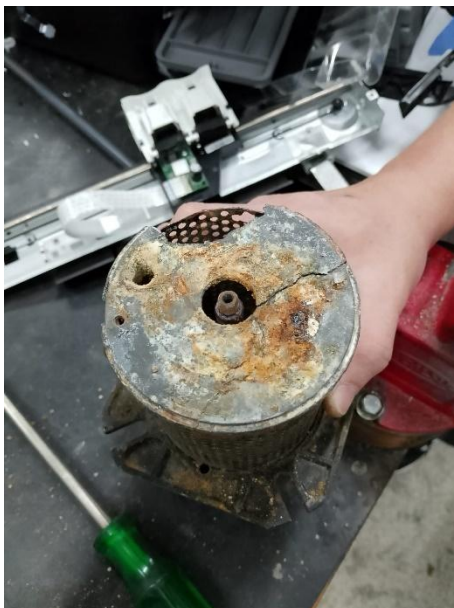
Figura 3 – Vista superior do filtro degradado
