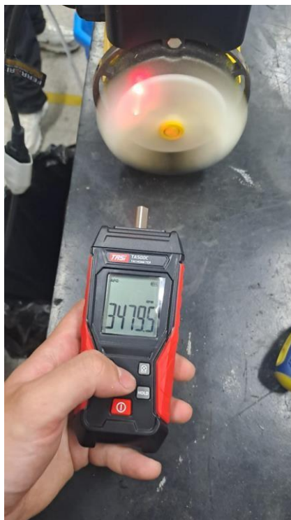
Figura 6 - Medição do RPM da bomba
