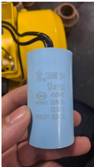
Figura 3 - Capacitor da bomba
