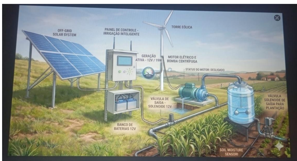
Figura 9 - Tela da IHM modernizada no software NBDesigner, representando o sistema de irrigação inteligente com todos os elementos visuais integrados - Estado com motor desligado
