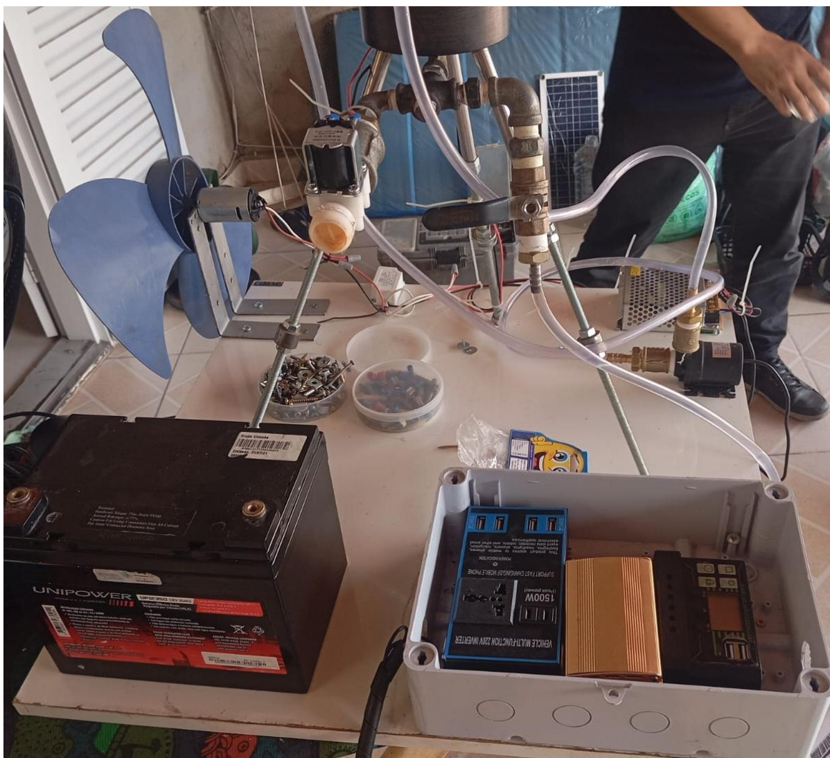
Figura 7 - Bateria estacionária UNIPOWER UP12350 (12V 35Ah) utilizada no subsistema de armazenamento de energia do protótipo.
