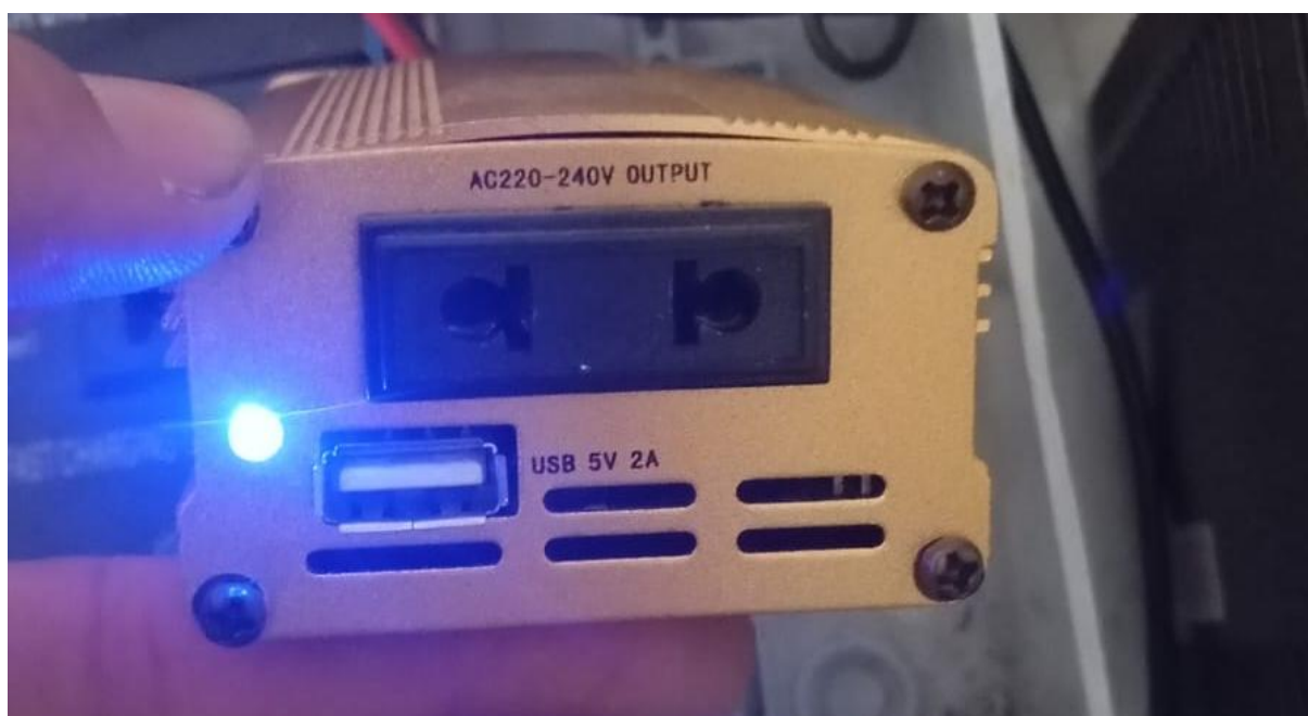
Figura 10 - Inversor de tensão de baixa potência (testado e descartado por insuficiência de capacidade)
