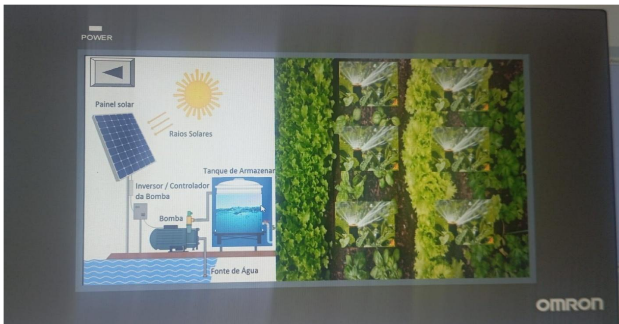
Figura 4 - Primeira tela da Interface Homem-Máquina (IHM) projetada no software NBDDesigner, representando o diagrama esquemático do sistema de bombeamento alimentado energia solar.
