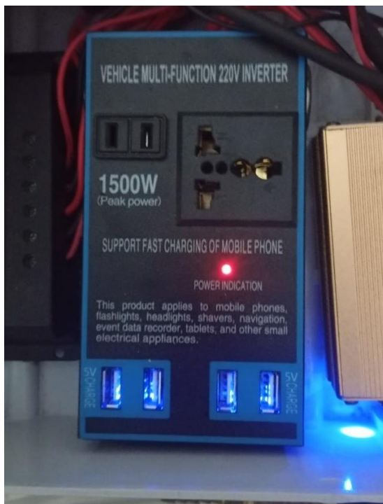
Figura 11 - Inversor de tensão multifunção 1500W (pico) – 220V, adotado para alimentar o sistema.
