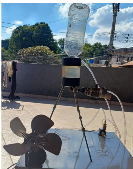
Figura 6 - Montagem da maquete funcional, sistema de bombeamento acionado diretamente por energia eólica (sem integração com CLP) e montagem do reservatório de água.
